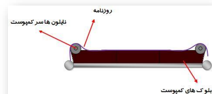
شکل ۴: طریقه قرار دادن روزنامه روی کمپوست
