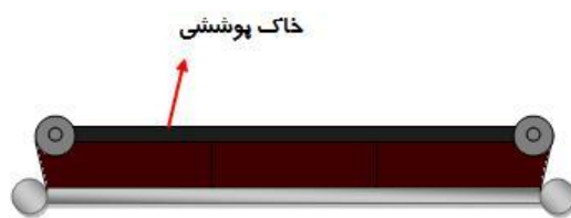
شکل ۵: نحوه قرار گیری خاک پوششی
