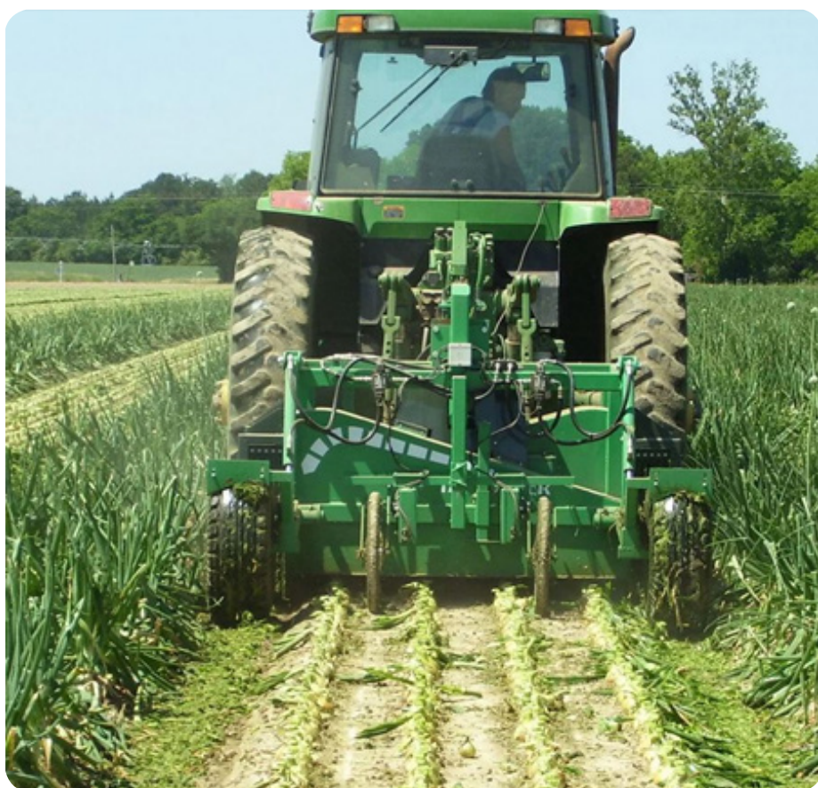
شکل ۲: ماشین سرزن بوته پیاز منضم به چرخ تنظیم ارتفاع
