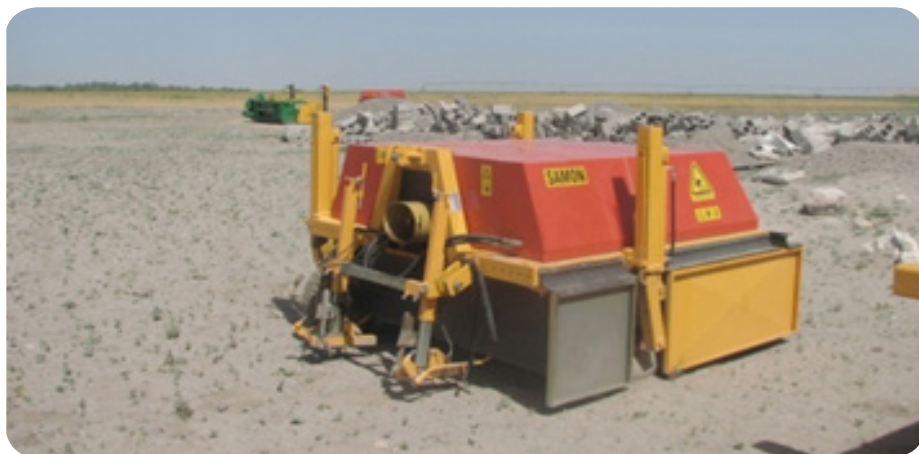
شکل ۳: یک نوع ماشین سرزن پشت تراکتوری مورد استفاده در مزارع پیاز ایران
