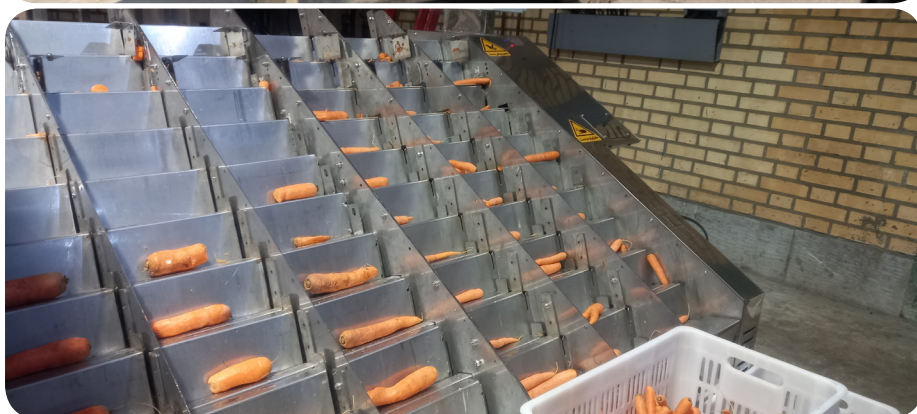
شکل ۱. نخستین دستگاه خودکار سر و ته زن هویج ساخت شرکت زیست سامانه پردیس
