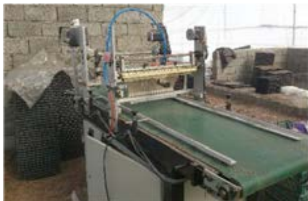
دستگاه کارنده بذر سینی نشاء
