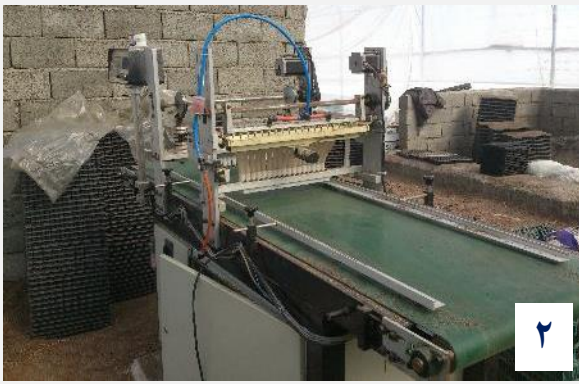
شکل ۲-۵. کاشت بذور در سینی نشاء. (۱) روش دستی؛ (۲) دستگاه کارنده بذور سینی نشاء
