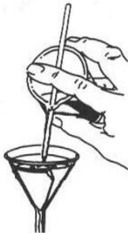
(شکل ۱-۴) انتقال مخلوط روی کاغذ صافی
