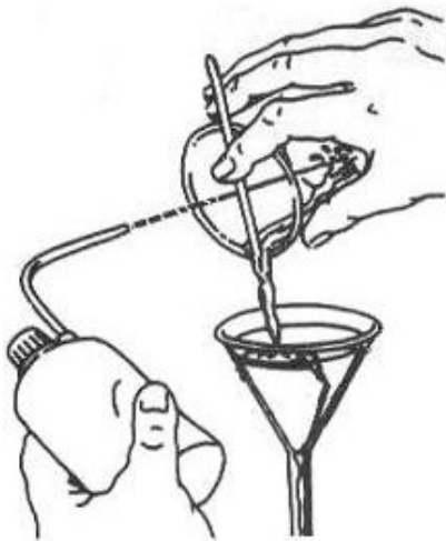
(شکل ۱-۵) انتقال باقی مانده رسوب روی کاغذ صافی
