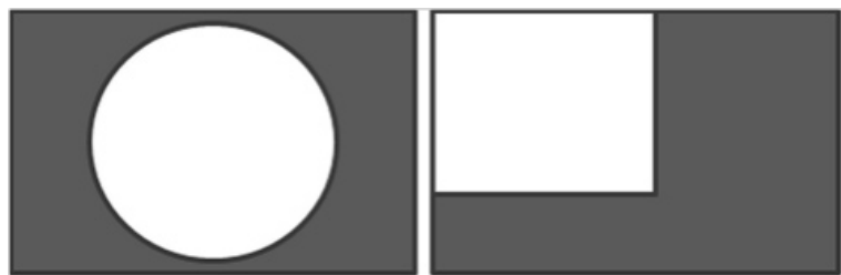
شکل ۱۵-۵. فیلترهای پایین‌گذر برای تبدیلات فرکانسی مختلف DFT(a), DCT(b)
