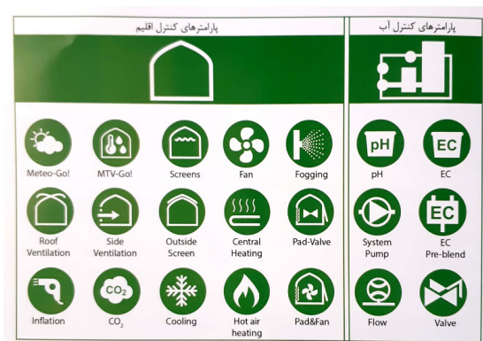
شکل ۳: نمای کلی از صفحه تنظیمات سامانه اتوماسیون گلخانه
